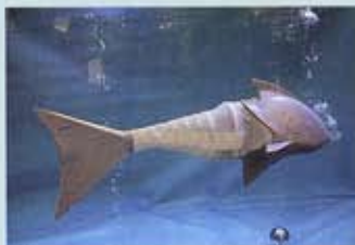
Airacuda: Der ferngesteuerte pneumatisch angetriebene Fisch folgt seinem biologischen Vorbild in Aufbau, Form und Kinematik.
