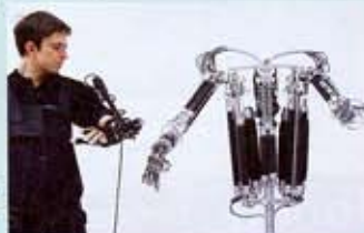
Auf der Erde, im Weltraum oder im Ozean: Der Humanoid realisiert mit 48 Freiheitsgraden hoch komplexe Bewegungsabläufe und arbeitet noch dort, wo es für Menschen nicht mehr möglich ist.
