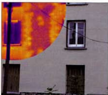
Visualisation des déperditions de chaleur sur une façade.
