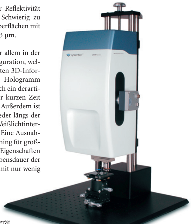
BILD 2. DHM-Gerät für Auflichtmessungen: 3-dimensionale Echtzeitaufnahmen mit nm-Auflösungen sind möglich
